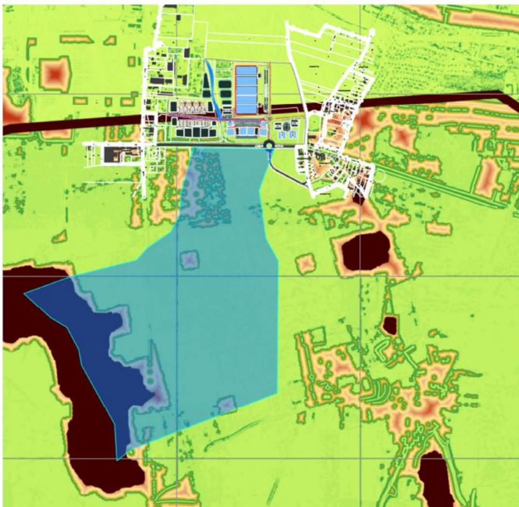
Figure 89 : Superposition du projet et des données IGN. Représentation du bassin versant intercepté en bleu (source : IDP)
